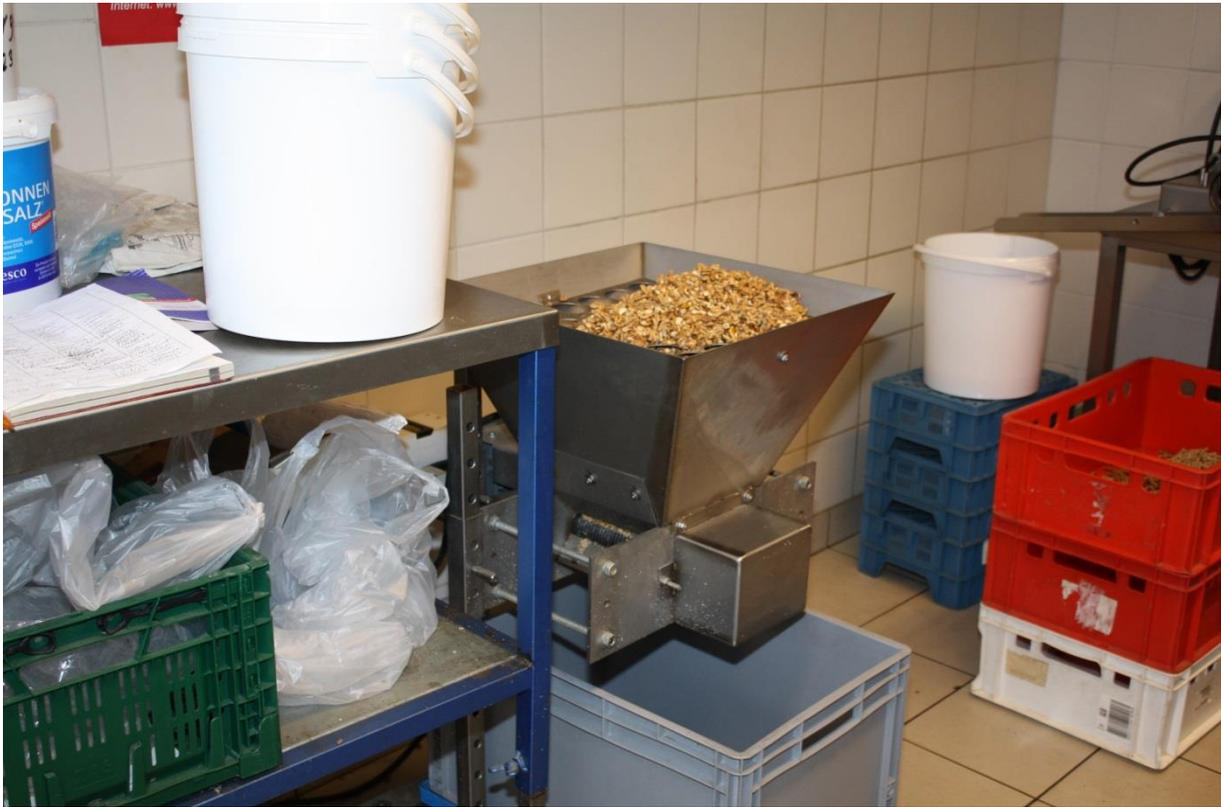
Ein weiterer Zwischenschritt zur Ölproduktion ist die Zerkleinerung der Nusskerne über einen Zerhacker.
