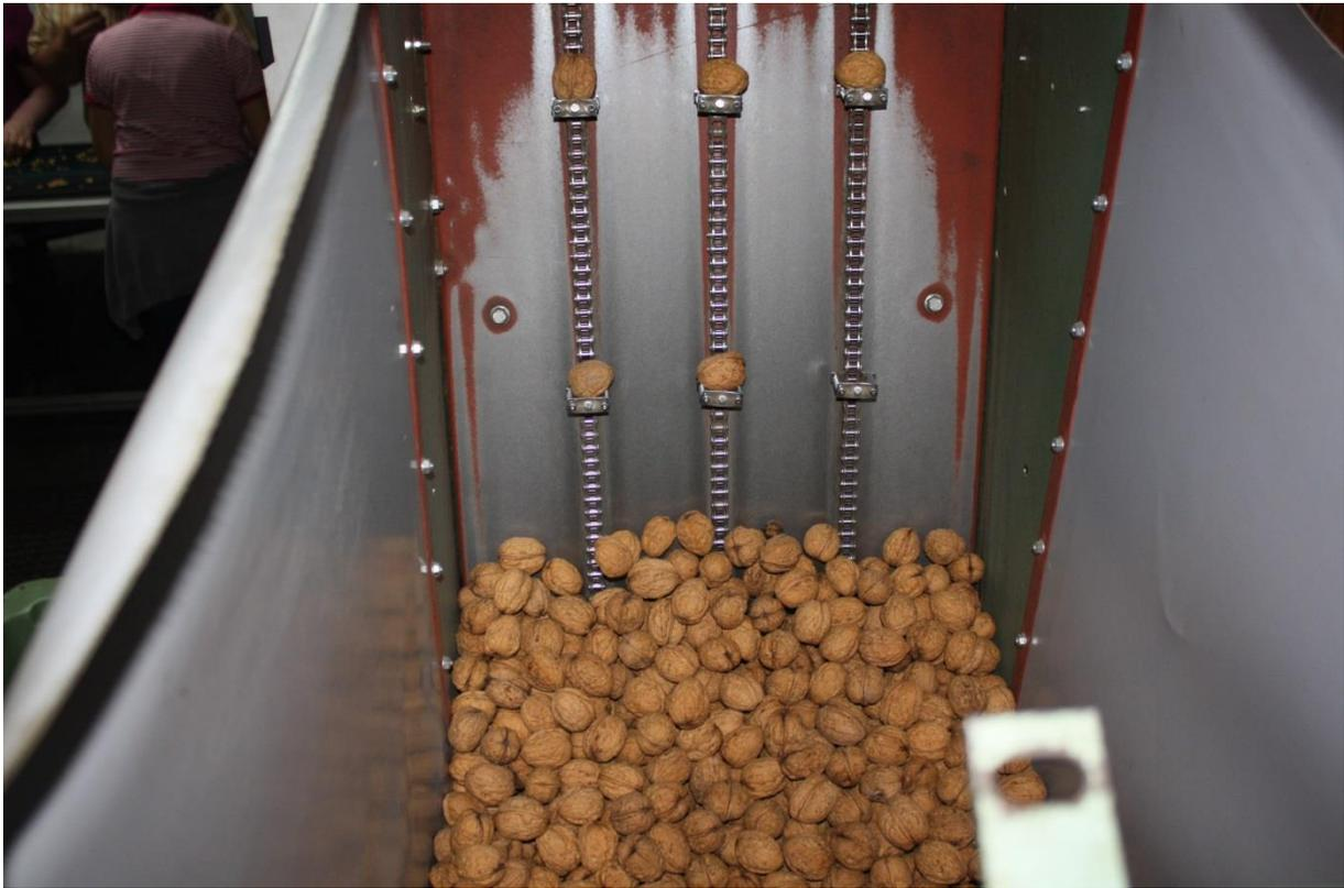
Zur Trennung von Kern und Schale werden die Walnüsse einzeln über Elevatorketten aus einem Vorratsbehälter entnommen und maschinell über einen Vorknacker und einen Nachknacker geöffnet. In Abhängigkeit vom Gewichtsverhältnis und der Lösbarkeit zwischen Schale und Kern wird in zwei Schritten, d.h. an beiden Knackmaschinen ein mehr- oder weniger hoher Anteil von Schalen bereits automatisch entfernt.
