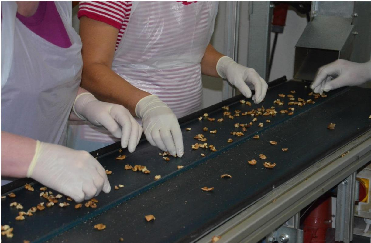
Über ein Sortierband müssen die restlichen Schalenteile händisch von den Nusskernen getrennt werden. Hier werden mit großer Sorgfalt auch schadhafte Kerne (z.B. durch Schimmelfeul oder schwarze eingeschrumpfte Nüsse) entfernt.
