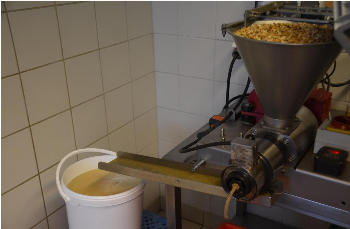
Das aus den Kernen, noch mit feinen Schwebstoffen leicht trübe, kaltgepresste Walnussöl läuft über eine Auffangrinne in einen dicht verschließbaren Eimer. Nach einer mehrwöchigen Ruhezeit setzen sich die im Öl enthaltenen Schwebstoffe ab, so dass das Öl seinen goldgelben, klaren Zustand erreicht.
